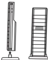
O transmissor possui um suporte que poderá ser afixado com dois parafusos que também foram fornecidos. O transmissor também pode ser colocado sobre uma superfície plana, encaixando o suporte na parte de baixo do transmissor.
