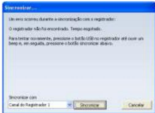
Para repetir o processo de sincronização coloque ambos dispositivo KlimaLogg Pro e software KlimaLogg Pro em modo de sincronização novamente. Para fazer isto favor pressionar o botão USB no dispositivo até ouvir um bipe, então clique no botão sincronizar no diálogo “Sincronizar”.
