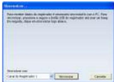
A sincronização pode ser iniciada manualmente a qualquer momento, selecionando “Registrador/sincronizar registrador” a partir do menu principal. Você pode realizar manualmente a sincronização de dispositivos adicionais, se o dispositivo KlimaLogg Pro e o dispositivo USB perderem contato ou se a instalação for concluída com êxito sem a sincronização bem sucedida entre o dispositivo e o PC.
