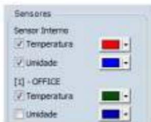
Usar caixa de seleção na frente do título Temperatura e Umidade para determinar se o valor do sensor deve ser sempre exibido no diagrama. Usar a rolagem de cores para determinar a cor da linha que representa o sensor no diagrama.
