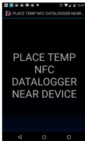
Aproxime o datalogger TEMPNFC próximo à antena NFC de seu smartphone (**Atenção! Os smartphones que possui a tecnologia NFC tem a antena colocada em diversas posições, depende do fabricante, mas geralmente fica na parte traseira do aparelho**), e não remover até que a tela fique de AZUL para VERDE. Se ficar VERMELHO, repita a operação e tenha cuidado para não mexer o datalogger para não dar o mesmo erro novamente.
