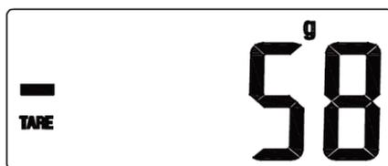
Pressione o botão “ON/TARE” por aproximadamente 4 segundos para desligar a balança. A balança desligará automaticamente se não for utilizada por 10 segundos.
