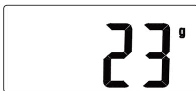
Pressione o botão “ON/TARE” para apagar a medição que é apresentada no visor e será apresentada a exibição “Tare” e “0g”. Em seguida, coloque no recipiente os alimentos ou ingredientes que você deseja saber o peso. O valor medido será exibido no visor da balança.
