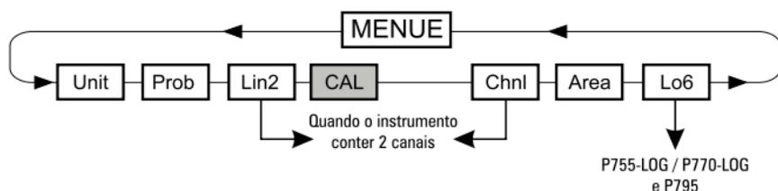
Com as teclas para cima ou para baixo (▲▼) você poderá optar entre rH para calibração da umidade ou P°C para calibração da temperatura.
