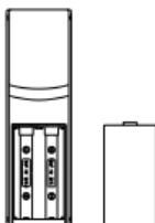
Il trasmettitore della temperatura monta 2 batterie tipo AA, IEC LR6, da 1,5V . Per installare e sostituire le batterie, seguire i passaggi descritti qui di seguito.
