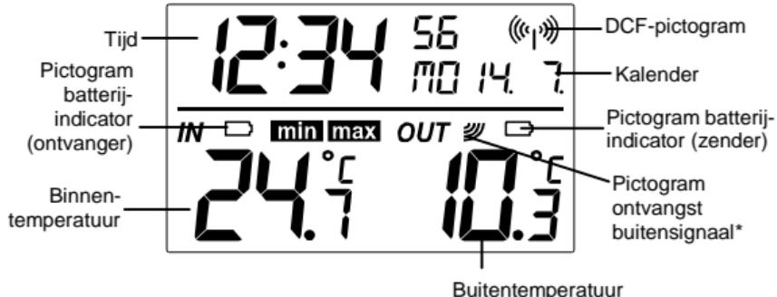
\* Als het temperatuurstation erin geslaagd is het signaal te ontvangen, blijft het symbol van signal buitenontvangst op het scherm staan (zoniet dan verdwijnt het). Er kan dus altijd worden afgelezen of ontvangst gelukt is (pictogram aan) of niet (pictogram uit). Daarbij geeft een knipperend pictogram aan dat een ontvangstpoging aan de gang is.
