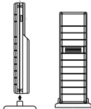
De zender wordt geleverd met een houder die met de twee meegeleverde schroeven aan de muur kan worden bevestigd. De zender kan ook op een vlakke ondergrond gezet worden. De houder moet dan aan de onderkant van de zender bevestigt worden.
