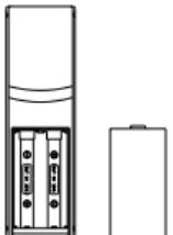
Der Außentemperatursender arbeitet mit zwei 1,5 V-Batterien vom Typ Mignon AA, IEC LR6. Folgen Sie beim Einlegen und Ersetzen der Batterien bitte den Schritten unten:
