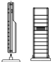
L'émetteur est fourni avec un support qui peut se fixer au mur à l'aide des deux vis fournies. On peut aussi le poser sur une surface plane et fixant le support à la base de l'émetteur.
