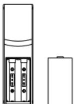
L'émetteur de température fonctionne avec 2 piles AA, IEC LR6, 1.5V. Pour les installer ou les remplacer, suivre les étapes ci-dessous :
