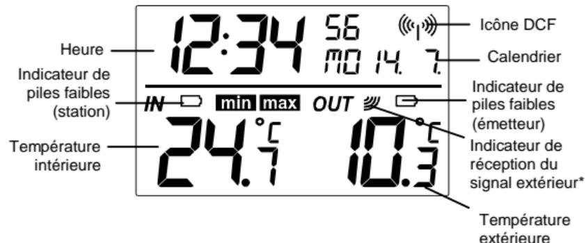
\* Lorsque le signal est réceptionné par la station de température, l'indicateur de réception du signal extérieur reste affiché à l'écran (l'icône ne sera pas affichée si la réception échoue). L'utilisateur peut ainsi s'assurer de la bonne réception du signal (icône affichée) ou de l'échec de réception (icône absente). Un signal de réception qui clignote indique une réception en cours des données extérieures.
