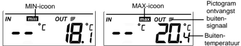
3. Druk driemaal op de MIN/MAX/+ toets om de MIN binnentemperatuur weer te geven en de tijd en datum van registratie weer te geven.
