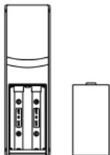
De temperatuurzender wordt gevoed door 2 x AA, IEC LR6, 1.5V batterijen. Volg onderstaande stappen voor het plaatsen en vervangen van de batterijen:
