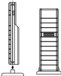
Der Außentemperatursender ist mit einem Halter ausgestattet, der mittels zweier mitgelieferter Schrauben an eine Wand montiert werden kann.
