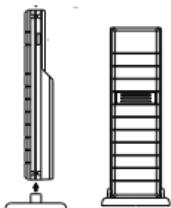
El transmisor viene provisto con un soporte o travesaño que puede ser colgado en una pared con los dos tornillos suministrados. El transmisor también puede ser colocado en una superficie llana asegurando el stand o soporte a la parte baja del transmisor.
