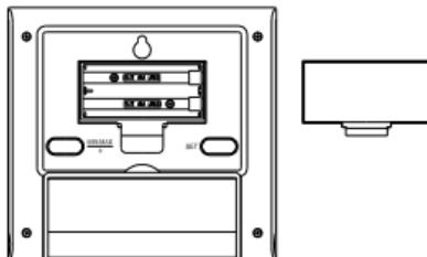
La station de température fonctionne avec 2 piles AAA, IEC LR3, 1.5V. Pour les installer ou les remplacer, suivre les étapes ci-dessous :
