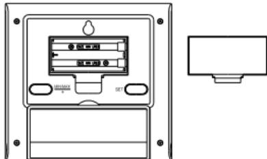
1. Entfernen Sie den Batteriefachdeckel an der Rückseite der Temperaturstation.
