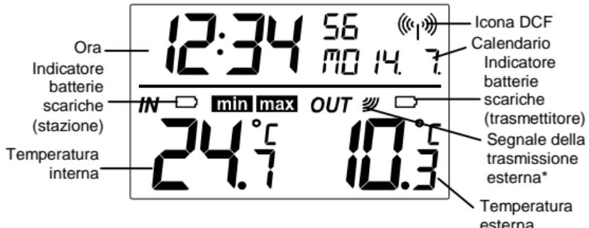
\* Quando il segnale proveniente dal sensore è ricevuto con successo dalla stazione della temperatura, si attiva l'icona della ricezione del segnale (se questo non avviene con successo, l'icona non si visualizza sul display a cristalli liquidi LCD). In questo modo l'utente può vedere facilmente se l'ultima ricezione è avvenuta con successo (icona attivata) o meno (icona disattivata).
