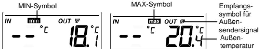
3. Drücken Sie zur Anzeige der minimalen Raumtemperatur und der Zeit und Datum der Speicherung drei Mal die MIN/MAX/+ -Taste.
