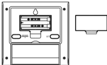
1. Togliere il coperchio del vano batterie sulla parte posteriore del stazione della temperatura.
