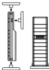
Il trasmettitore è fornito di supporto che può essere montato al muro con le due viti in dotazione. Il trasmettitore può anche essere sistemato su una superficie piana assicurando il supporto sulla parte inferiore del trasmettitore.
