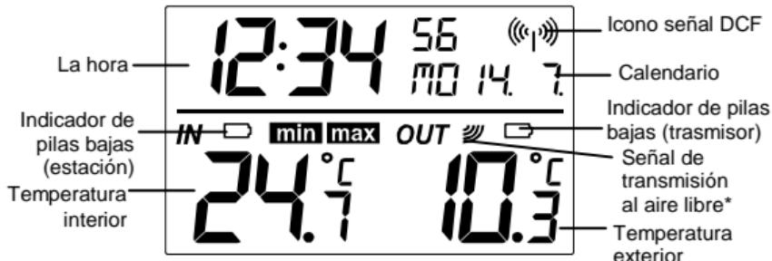
\* Cuando la señal sea recibida correctamente, el icono se encenderá. (Si la señal no se recibe correctamente el icono no aparecerá en la pantalla.) De esa manera el usuario puede ver fácilmente los datos de la última recepción exitosa de la señal (ícono encendido) ningún ícono (ícono apagado) de otra manera, el ícono pequeño que titila en la pantalla señala que ya se recibió la recepción.
